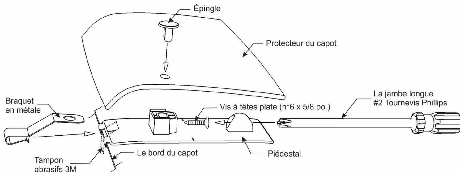
1. Commencer un #6 x 5/8 vis de tête plate dans chaque quelques virages de piédestal. La pointe de la vis ne doit pas dépasser dans le trou où l'épingle d'attachement installera plus tard. Utiliser un crayon de mètre et graisse marque le centre du capuchon, et les positions : deux piédestaux sont des **200mm** à gauche et à droite de la marque au centre du capot. Voir illustration n°1. Pointe : Utiliser des trous sur le dessous du cadre de capuchon pour aider le centre de capuchon localiser.
