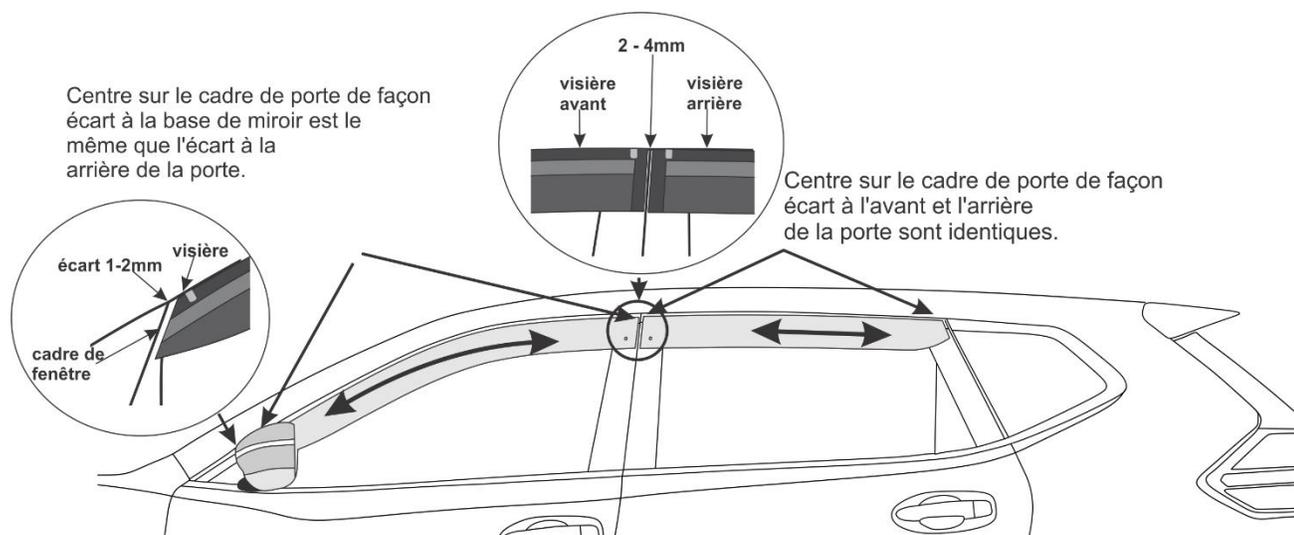
5. Nettoyer toutes les surfaces de montage agressive avec nettoyant de surface d'essuyage pour enlever les empreintes de doigt, d'huiles, cires que peut être sur la surface. Prenez soin de ne pas contaminer la surface après le nettoyage. Les contaminants de surface permettra de réduire l'adhérence de la bande de 3M.
